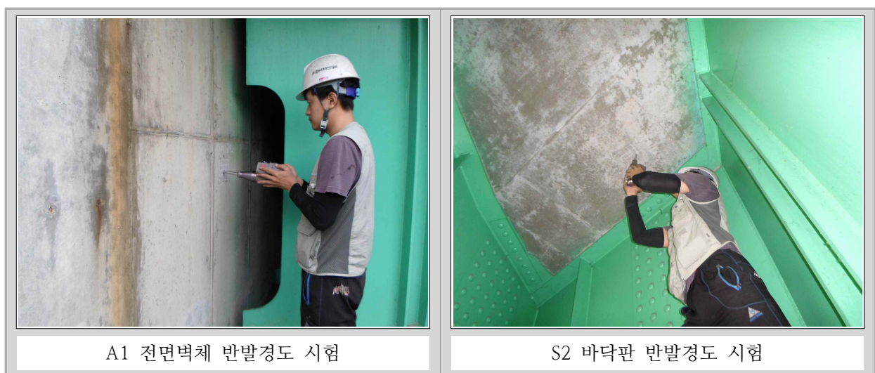
〈그림 2.2.1〉 반발경도시험 현황
